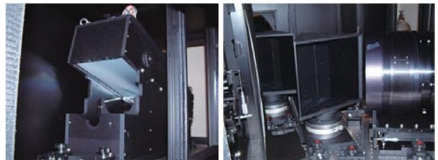
図 4-2 BOES のモザイクエシエル（左）とクロスディスペーザープリズム（右）
