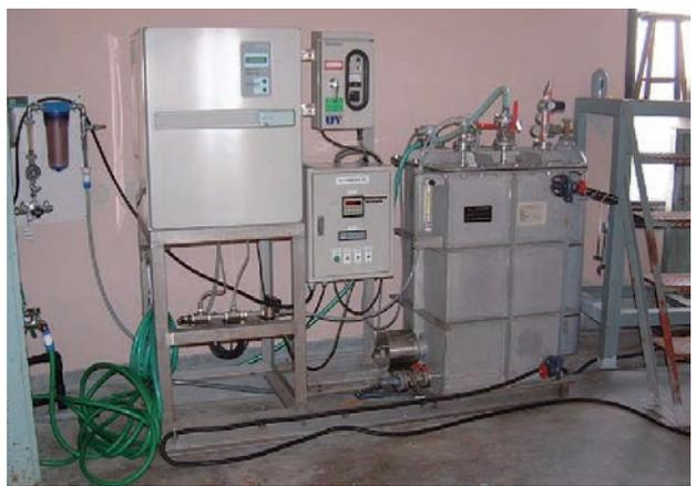
図 2-51 純水製造装置
