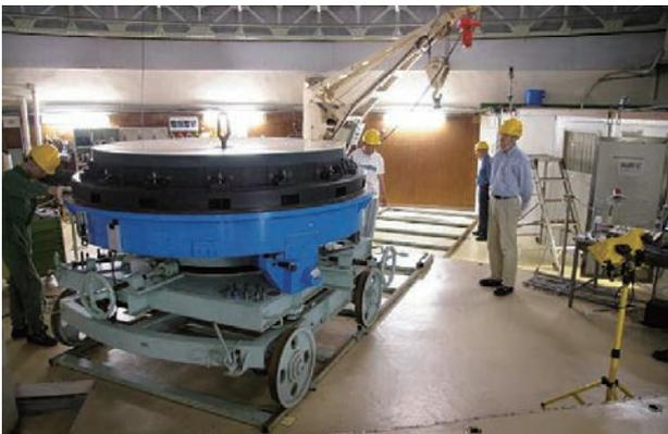
図 2-52 望遠鏡から主鏡を取り出す
