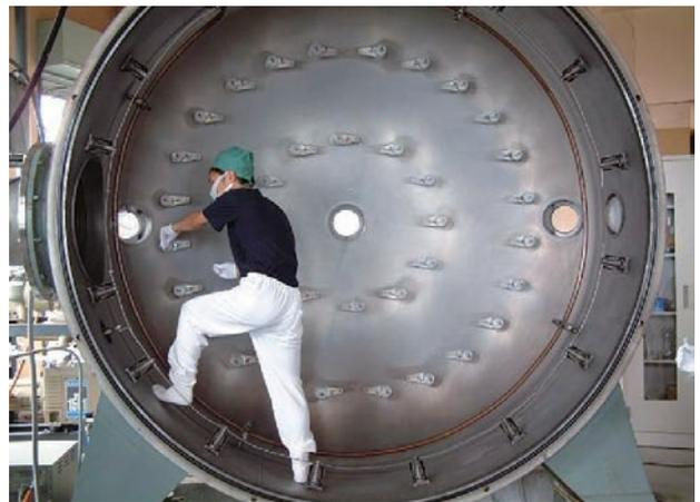
図 2-55 蒸着班によるフィラメントの取付
