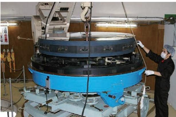
図 2-53 蒸着後の主鏡をセルに納める
