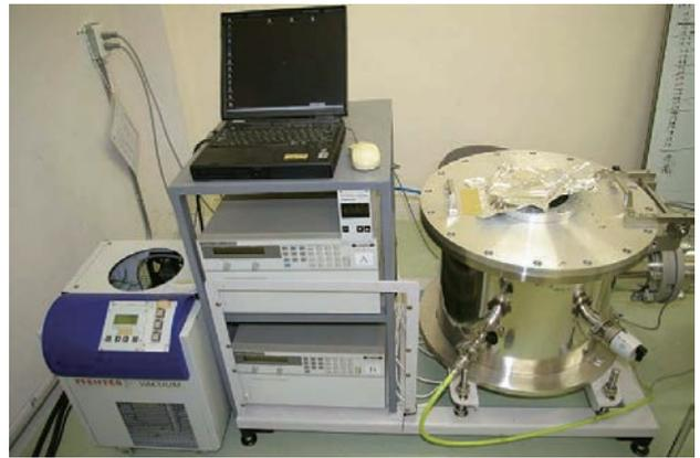
図 2-59 プリウエットフィラメントの準備に使用する小型蒸着装置
