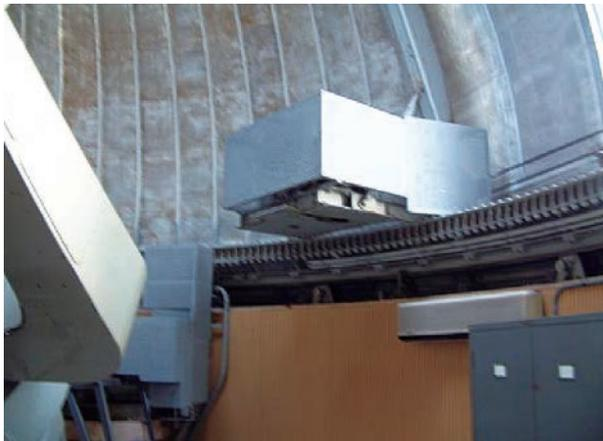
図 2-77 スリット開閉ギア、モーター部
