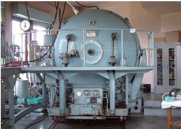
図 2-48 蒸着装置全景
