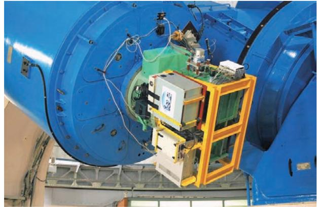
図 2-20 188cm 反射望遠鏡のカセグレン焦点に取り付けられた ISLE
