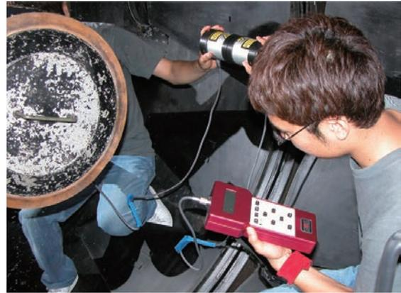
図2-61  $\mu$ Scanによる主鏡反射率の測定。
