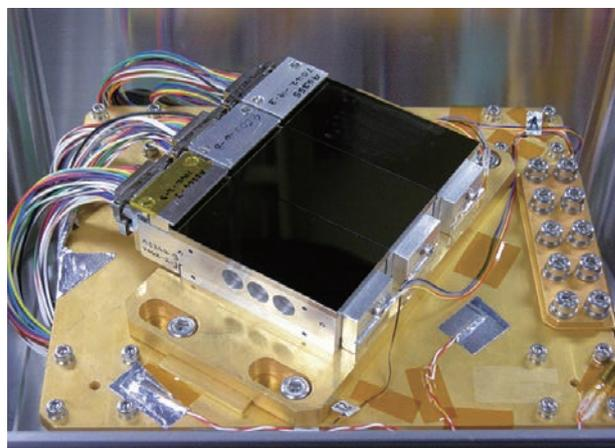
図 2-11 クライオスタットに組み込まれた、EEV 42-80 型の CCD を三個並べたモザイク CCD。CCD 同士の間は 0.5mm だけ離してある。中屋秀彦氏により開発されたアナログ読み出し回路 Mfront2 により読み出される。
