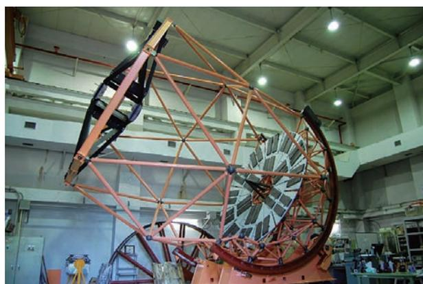
図5-4 名古屋大学で仮組中の高度軸構造
