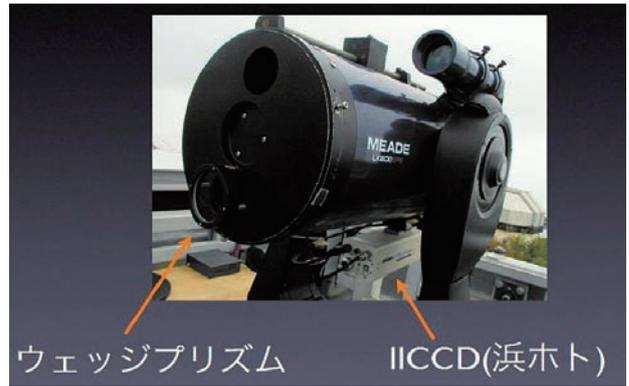
図 2-45 シーイングモニター (DIMM) 本体
