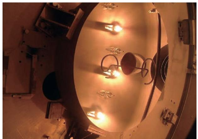
図 2-57 アルミニウムを熱したフィラメントで蒸発させ鏡面を作った瞬間(91cm 反射望遠鏡主鏡)
