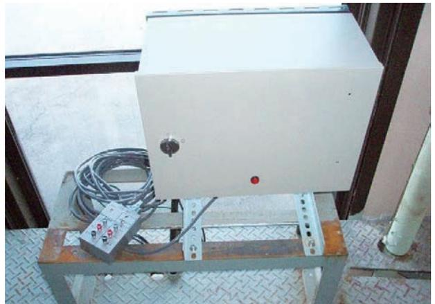
図 2-50 改造した蒸着タンク駆動制御箱
