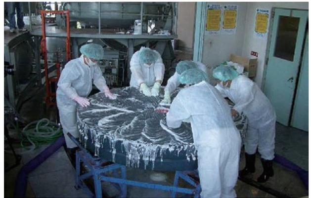
図 2-54 洗浄班による主鏡の重層磨き
