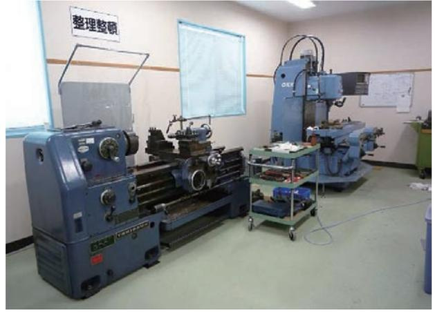
図 2-39 実験工場内の精密旋盤（左）と半自動フライス盤（右）
